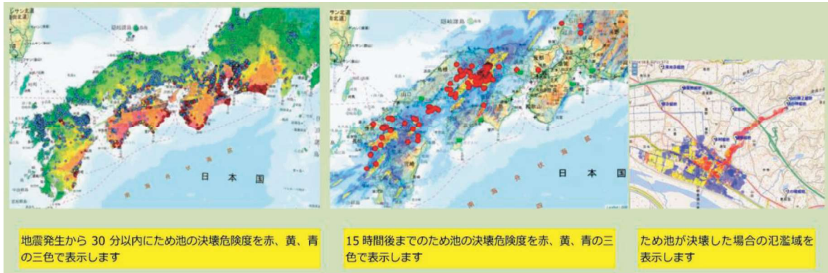
左図：地震発生時のため池の決壊危険度を表示した図 中図：豪雨時のため池の決壊危険度を表示した図 右図：決壊した場合の氾濫域を表示した図
