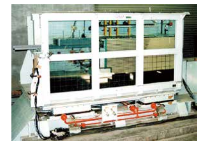
模型振動実験土槽 * 公益財団法人鉄道総合技術研究所にて実施
