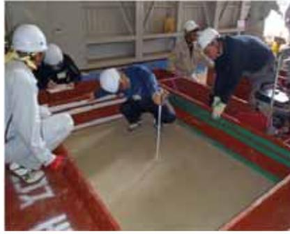
写真2 事前締固め試験
