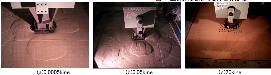
写真1 地盤の破壊状況
